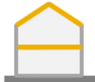
Gebouw mix zware muren + houten vloer/structuur
