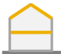
Gebouw mix zware muren + houten vloer/structuur
