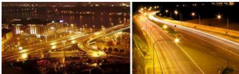
Exemple : Sodium basse pression – Ra ≈ 22
