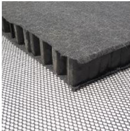
Ultralichte alveolaire structuren – Bron: www.nidaplast.com
