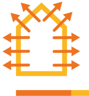
SLECHT GEÏSOLEERD GEBOUW
