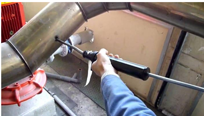
Figuur 8.2 - Opaciteitsmeter - Bacharach-index
