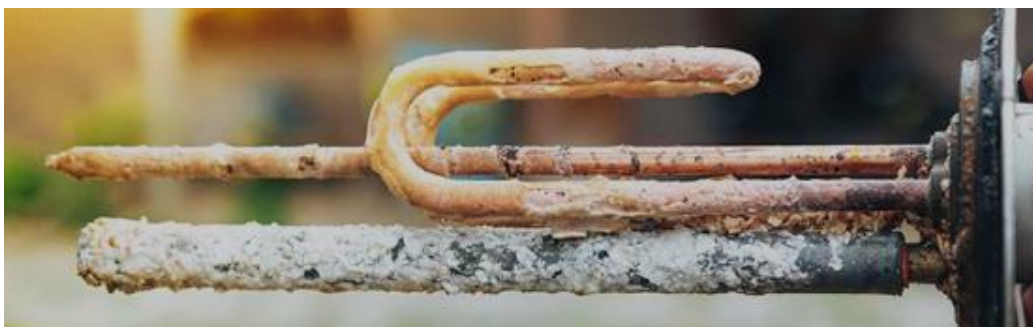
Figuur 9.1: Met kalkaanslag bedekte opofferingsanode (onder)
