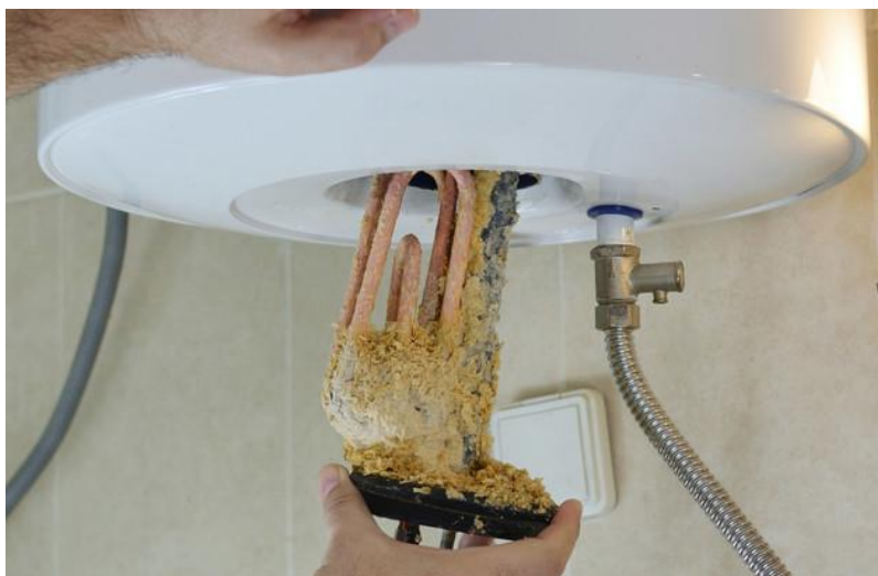
Figuur 9.2: Met kalkaanslag bedekte buisweerstand
