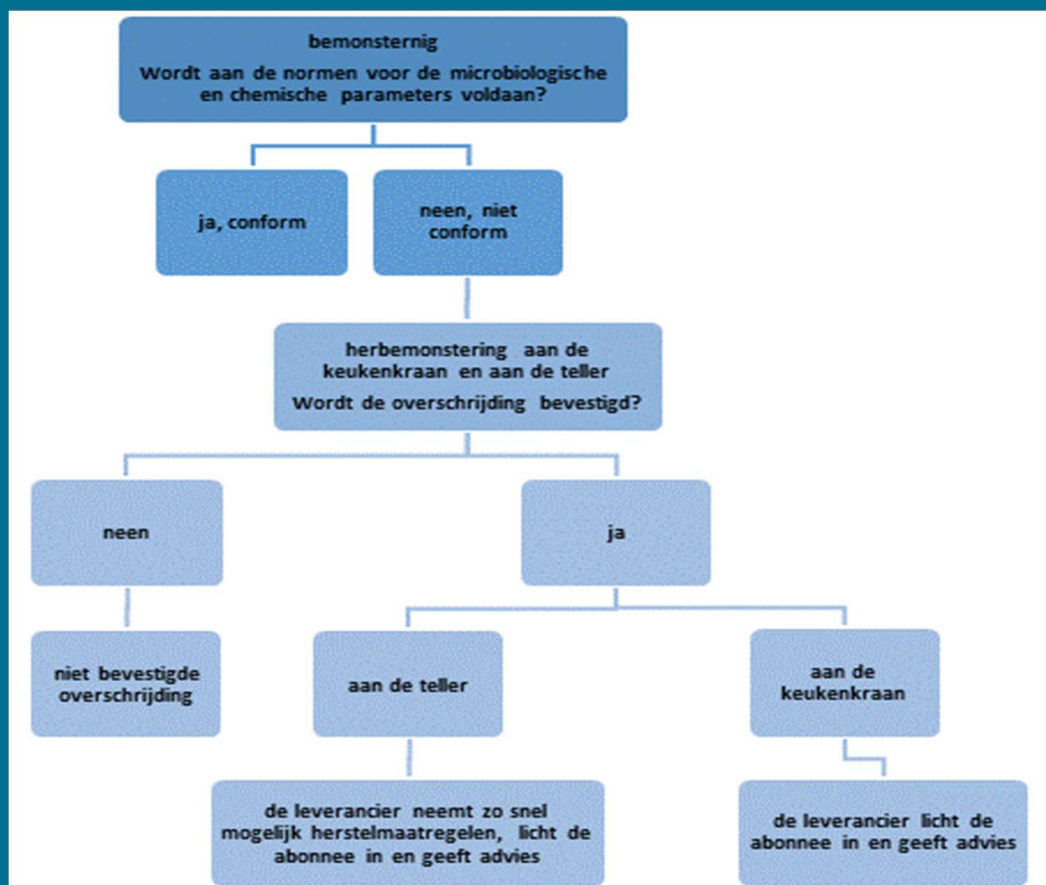
Figuur 4: schematische voorstelling van het onderzoek bij een normoverschrijding van een microbiologisch of chemische parameter
