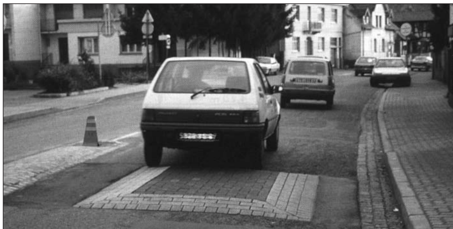
Rijbaankussens op een weg breder dan 7,40 m (Bron: Certu, Guide des coussins et plateaux, 2000)
