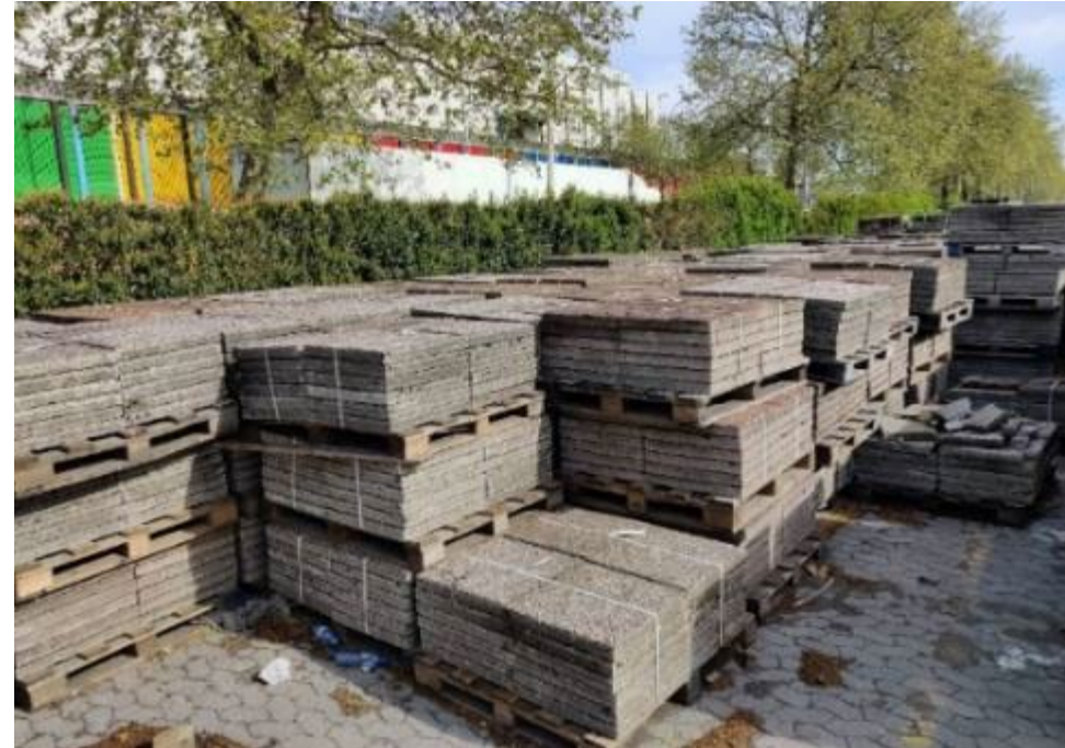
Silex-tegels afkomstig van WTC-complex opgeslagen en gereinigd (Project Zin, Befimmo) >
