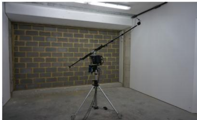
Fig. 81 Ouverture d'essai de 395 x 242 cm pour les murs, les cloisons massives et/ou vitrées et les grandes fenêtres.
