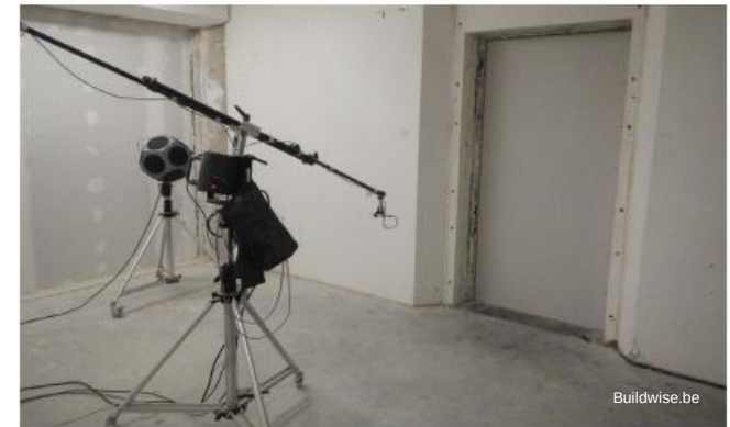
Fig. 82 Ouverture d'essai de 99 x 216 cm pour portes.
