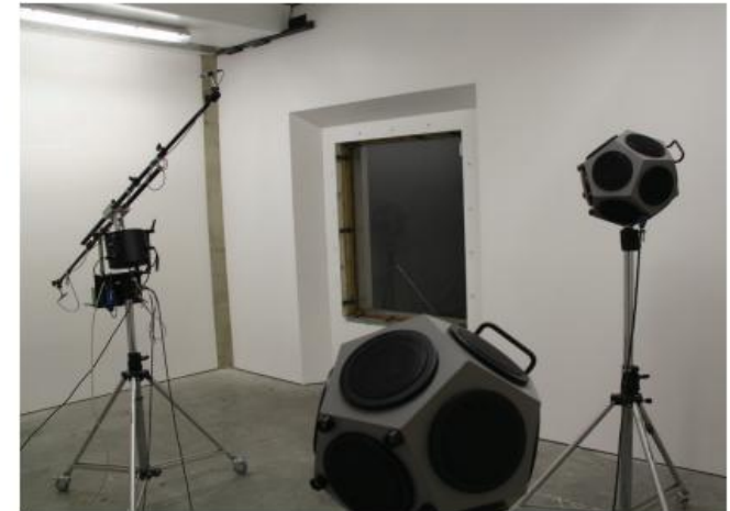
Fig. 80 Ouverture d'essai de 125 x 150 cm pour vitrages, fenêtres et petits panneaux.
