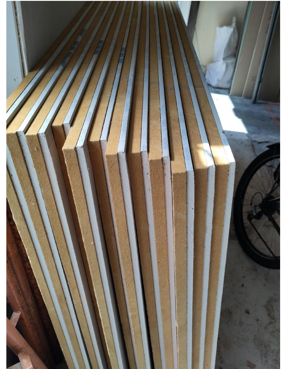
Afwerking uit sandwichplaten houtvezel/ gips-vezels
