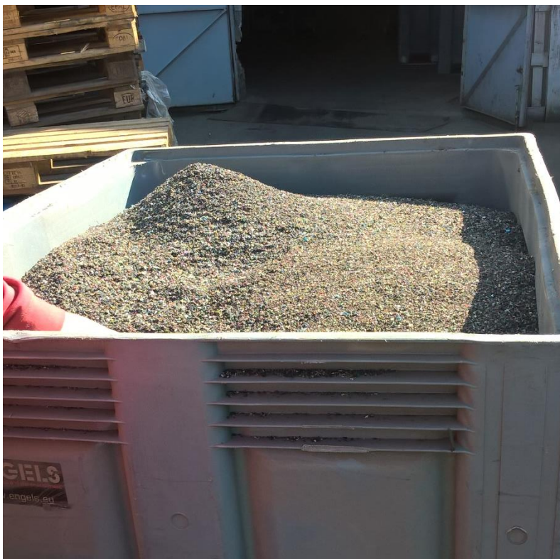
Foto 4: Kunststofafval (PVC) afkomstig van de verwerking van elektrische kabels.
