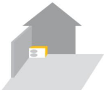
PAC placée dans un coin : + 6 dB(A)
