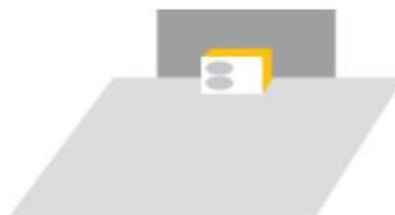
PAC placée contre un mur : + 3 dB(A)
