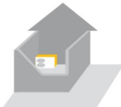
PAC placée dans une cour intérieure : + 9 dB(A)
