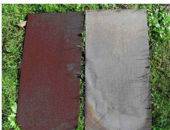
Rechts een leisteel van asbestcement (gewafelde textuur) en links een leisteel zonder asbest (met 'NT'-vermelding)
