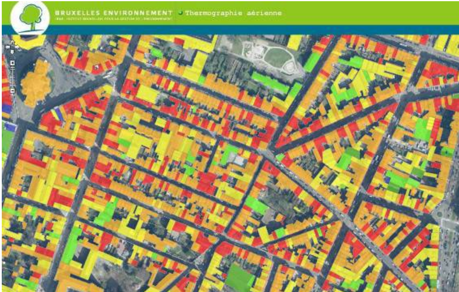
Infrarood luchtthermografie van de daken van de Brusselse gebouwen Bron: Leefmilieu Brussel
