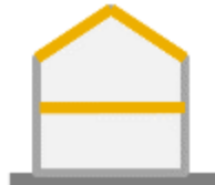
Gebouw mix zware muren + houten vloer/structuur
