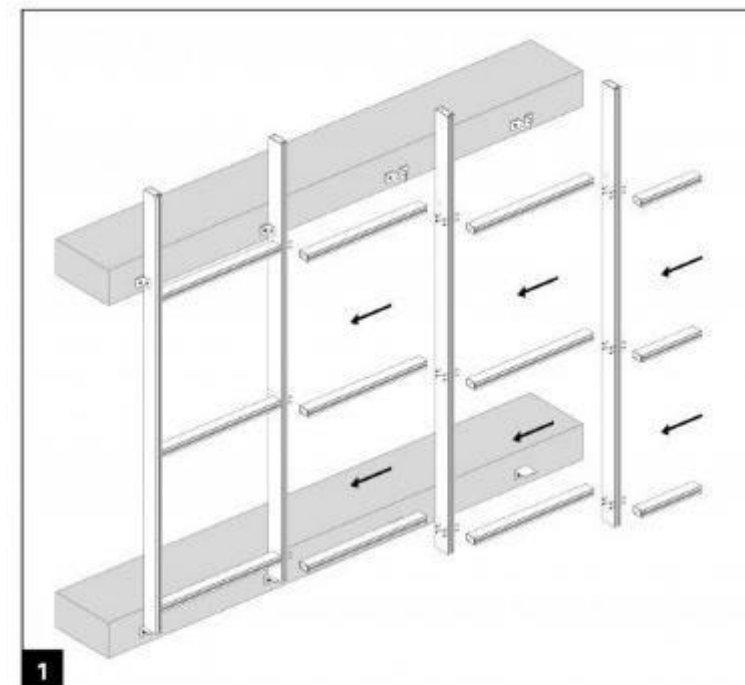
Steckbauweise Méthode de construction modulaire
