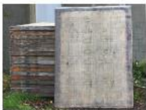
Panneaux de coffrage
