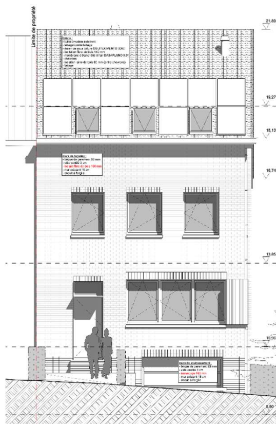
Vooraanzicht – Ontwerp – NA Isolatie langs de buitenzijde
