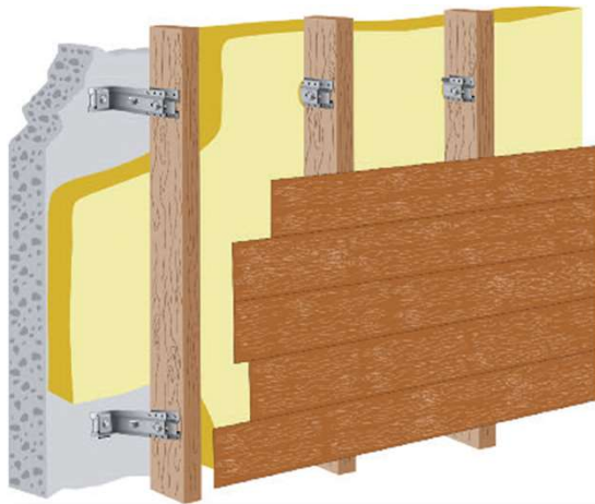
Metaal dat door de isolatie gaat
