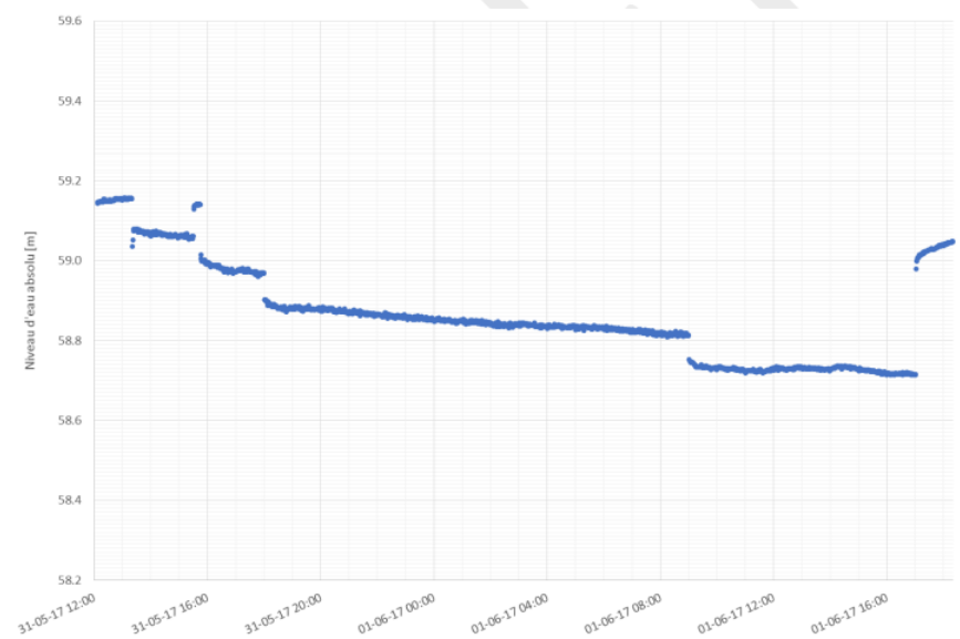
Figure 3-3 : Evolution piézométrique dans le PP1 lors du pompage d'essai par paliers
