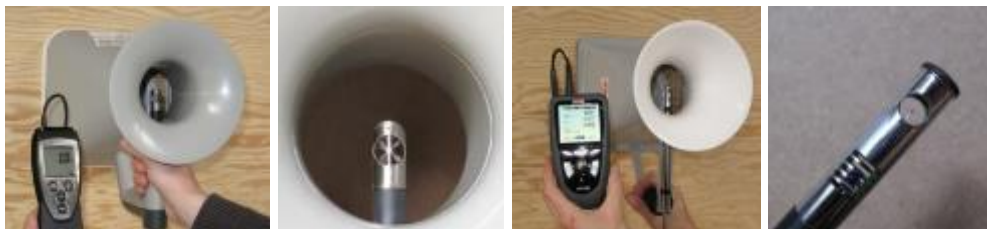
Kleine sonde + conus (vleugelrad of thermisch)
