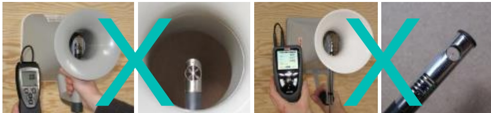
Kleine sonde + conus (vleugelrad of thermisch)
