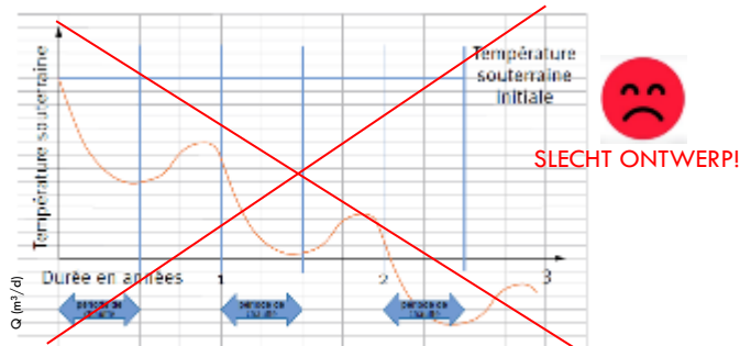
Fig. 4 Evolution de la température souterraine en cas de déséquilibre
